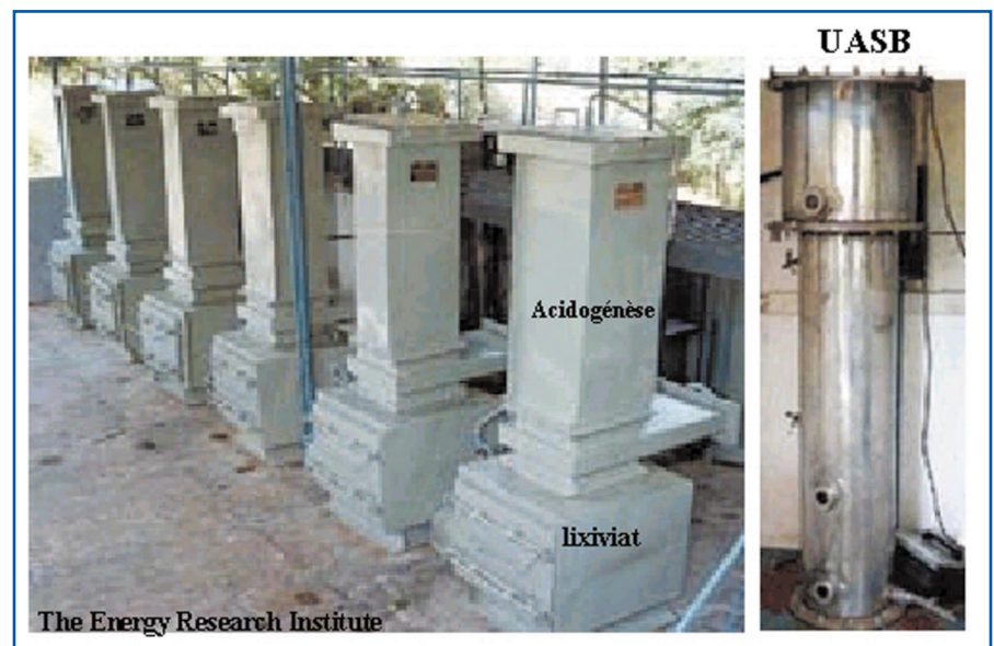
Figure 2 : Photo du pilote avec les six réacteurs d'acidogénèses et le réacteur de méthanisation UASB (TERI).
