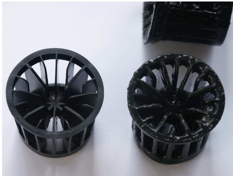
Figure 6 : Bioflow 30 de chez Raushert® avant et après formation du biofilm.
